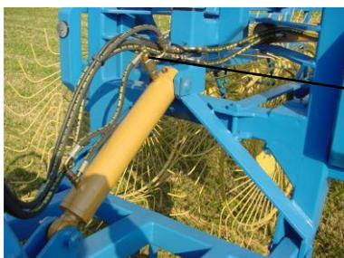
Para regular la altura de la parte trasera debe abrir el grifo del pistón delantero, accionar el mando a distancia de simple efecto hasta la altura deseada y volver a cerrar el grifo. En los modelos pajeros puede fijar esta altura con los muelles de tope traseros.
